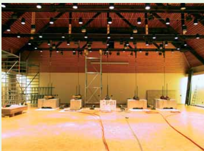
Abb. 15: Belastungsversuch der Kantholzbinder
